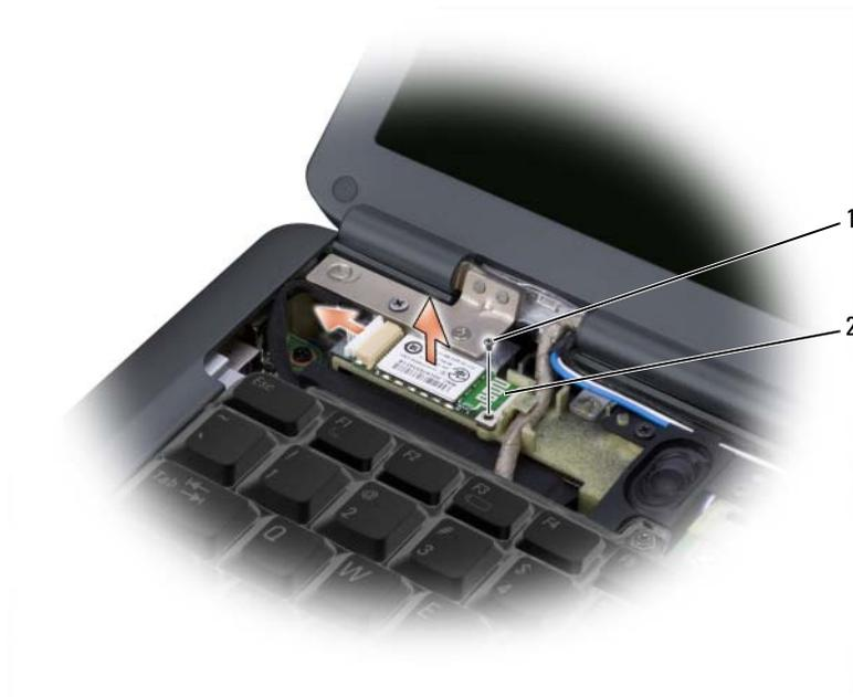
1 parafuso de fixação 2 placa
