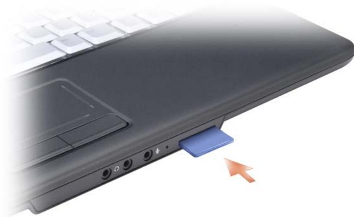
O computador reconhece a placa de memória e carrega automaticamente o driver de dispositivo apropriado. Se o programa de configuração pedir que você carregue os drivers do fabricante, use a mídia fornecida com a placa de memória, se aplicável.
